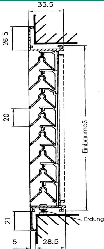
Wetterschutzgitter Typ 412 aus Aluminium für Mauereinbau mit Insektenschutzgitter aus Edelstahl V2A
