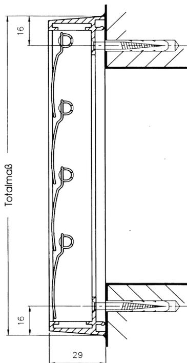
Überdruckklappen Typ 433 aus Aluminium für Wandanbau
