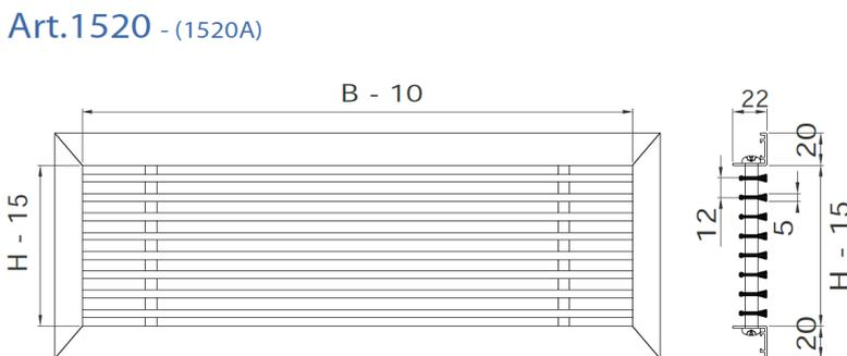
**Art. 1520** Lineargitter aus Aluminium eloxiert, mit geraden Lamellen.
