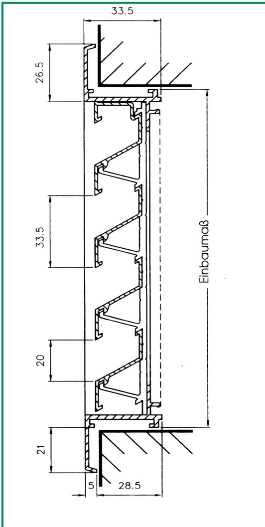
Wetterschutzgitter Typ 411 aus Aluminium für Mauer einbau mit Insektenschutzgitter aus Edelstahl V2A
