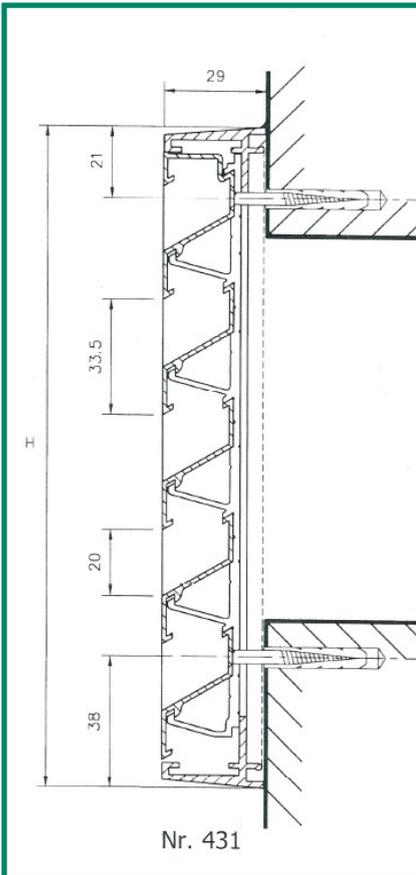
Wetterschutzgitter Typ 431 aus Aluminium für Wandanbau mit Insektenschutzgitter aus Edelstahl V2A
