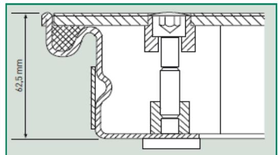
Schachtabdeckung mit Deckelplatte aus Stahl verzinkt.
