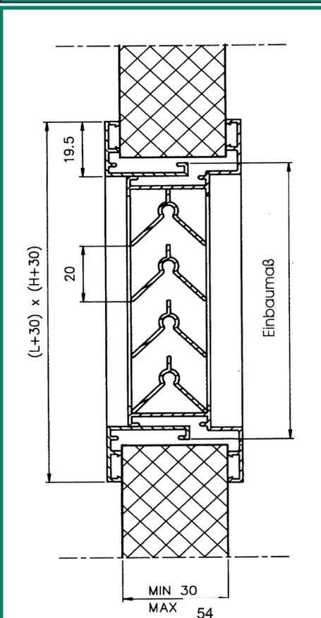
Wetterschutzgitter Typ 461 aus Aluminium für Türstärken min. 30, max. 54 mm
